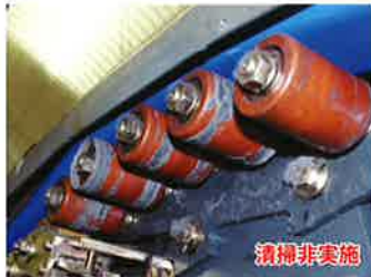
従来まったく対策されていなかったローラーの汚れを定期清掃により除去することで、ベルト汚れを防止する
