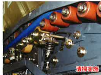
従来まったく対策されていなかったローラーの汚れを定期清掃により除去することで、ベルト汚れを防止する
